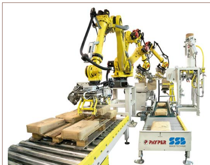
Abb. 5: Die All-in-one-Kompletanlage bestehend aus: Pneumatikpacker, Sackmagazin, Roboter-Aufsteckarm sowie Roboterpalettierer und Palettentransportsystem
