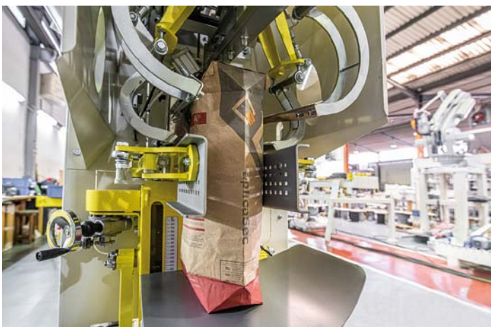
Abb. 2: Der Pneumatikpacker PFG-10 ermöglicht ein produktschonendes Abfüllen.
