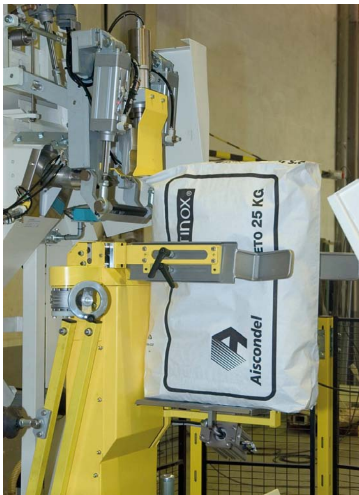
Abb. 4: Die Ultraschallverschweißeinrichtung oberhalb des Füllstutzens
